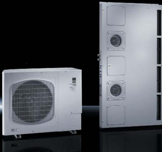
■ Холодильный агрегат с инвертерной технологией позволяет производить регулировку числа оборотов компрессора. Регулировка количества хладагента осуществляется с помощью электронного расширительного клапана. Адаптация мощности охлаждения к потребностям обеспечивает экономию электроэнергии до 40 %. Внутренний блок (испаритель) выдувает холодный воздух перед 19" плоскостью, теплый воздух забирается в задней части сейфа.
