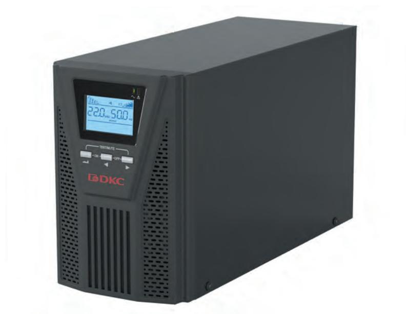
Small Tower - серия однофазных ИБП с технологией двойного преобразования (онлайн). Имеют конструктивное башенное исполнение и мощность от 1 до 3 кВА. Устройства этого класса служат для обеспечения бесперебойной работы серверов, сетевого оборудования, газовых котлов, промышленных ПЛК.
