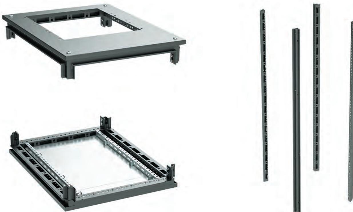
Стойки R5КМН крепятся к крыше и крепятся к дну R5КТВ\*\* с помощью резьбового соединения. Точность позиционирования вертикальных силовых профилей относительно дна и крыши обеспечивается конструктивно. Сборка осуществляется только с помощью отвертки и гаечного ключа.
